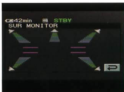
▲ Специальная диаграмма позволяет оценить степень многоканальности записываемого звука
